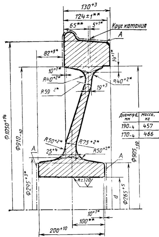
\* Размеры обеспечиваются инструментом.
