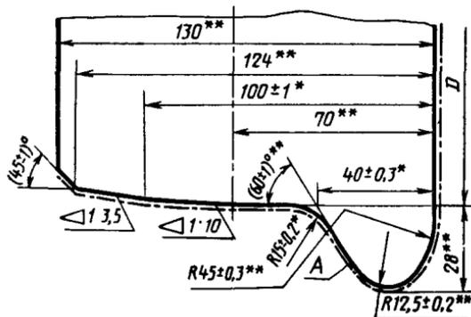
\* Размеры  $(100 \pm 1)$  мм;  $(40 \pm 0,3)$  мм;  $(R 15 \pm 0,2)$  мм, а также  $(45 \pm 1)^{\circ}$  обеспечиваются инструментом.
