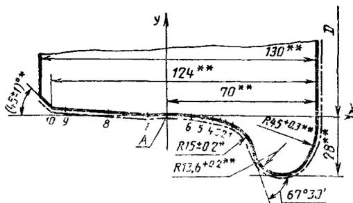
\* Размеры обеспечиваются инструментом.
