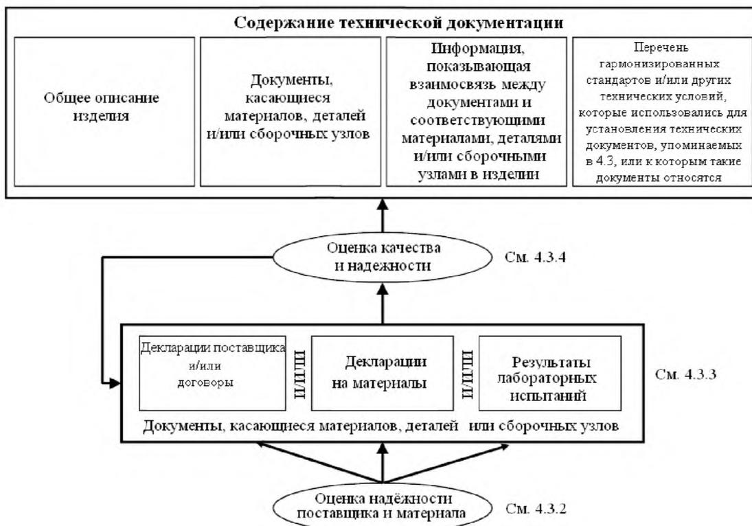
Рисунок 1 — Схематическое представление процесса создания технической документации
