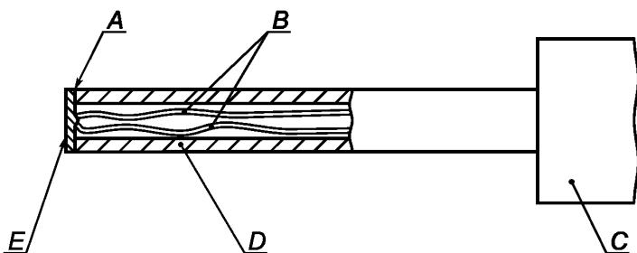
А – связывающее вещество; В – термопара из проволоки диаметром 0,3 мм типа К (хромоникелевый сплав) по IEC 807/02; С – ручное устройство, разрешающее контакт силой  $(4 \pm 1)$  Н; D – поликарбонатная труба с внутренним диаметром 3 мм, наружным диаметром 5 мм; Е – покрытый оловом медный диск диаметром 5 мм, толщиной 0,5 мм.
