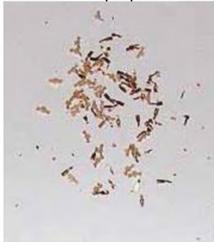
Рисунок Е.9б — Металлические выводы после разделения
