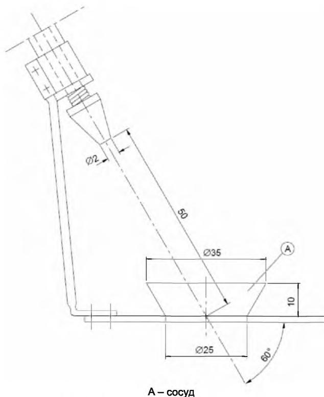
Рисунок 101 – Устройство для испытания обрызгиванием
