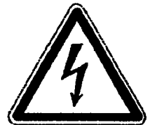
Опасное электрическое напряжение
