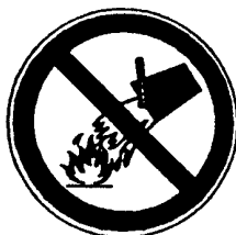
Тушение водой запрещено
