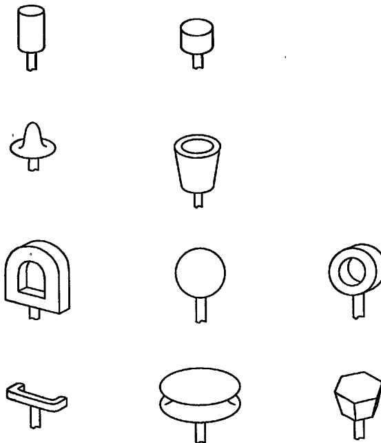
Рисунок 4 – Образцы осязаемых сигналов на органах управления, различаемые при прикосновении к ним
