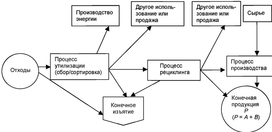
Рисунок А.1 – Упрощенная схема представления системы рециклинга
